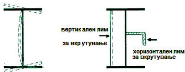
Сл.9.12 Вертикално и хоризонтално ребро за зацврстување
